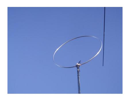
In uso antenna WELLBROOK ALA1530AL, ottimo loop per sola ricezione 100 KHz-30 MHz
